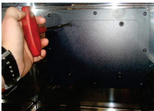
Figura n°19 - Acceso a los tornillos para retirar la tapa de la escotilla
